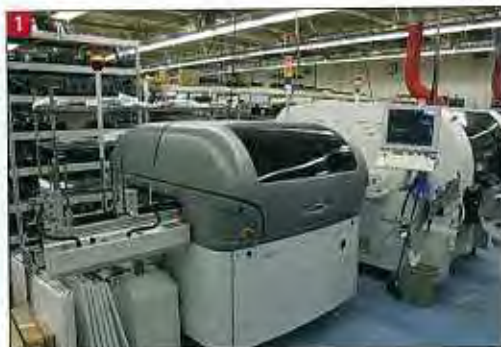
1 - I circuiti stampati vengono realizzati in outsourcing ma sempre a Binghamton. Il montaggio dei componenti avviene invece all'interno dell'azienda: nella foto la macchina che realizza il montaggio con la tecnica SMD (surface mounting device).
